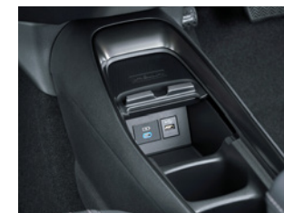
③充電用USB端子 (Type-C) / 通信用USB端子 [GR SPORT、Zに標準装備。通信用USB端子 (USB入力) は全車に標準装備]
