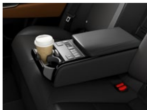
リヤセンターアームレスト（カッ プホルダー＋トランクスルー機能 ＋ボックス＋各種コントロールス イッチ付）& リヤオーディオコン trol
