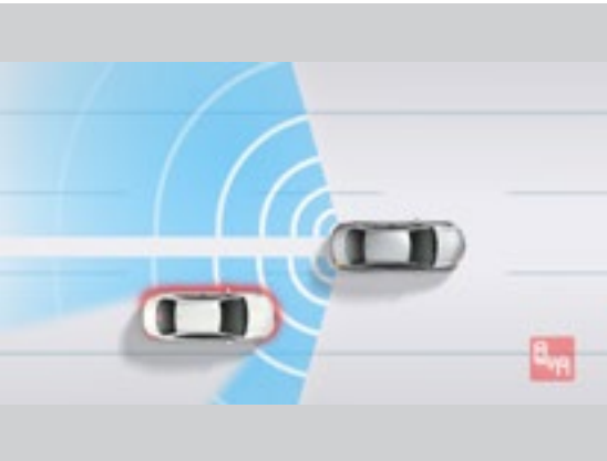
ブラインドスポットモニター [BSM] /後方車両への接近警報
