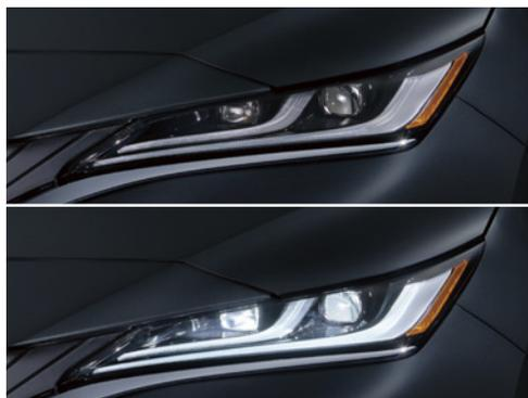
▶ **プロジェクター式LEDヘッドランプ(オートレベリング機能付) + LEDデイトタイムランニングランプ + LEDクリアランスランプ + LEDターンランプ**
