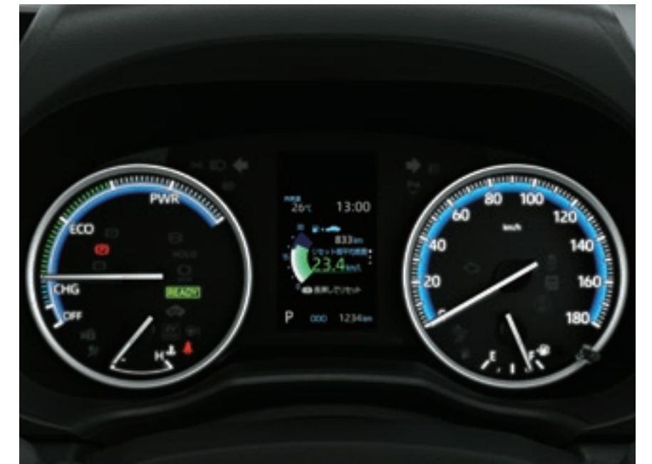
オプティロンメーター＋4.2インチTFT カラーマルチインフォメーションディスプレイ [S-G、G、Xに標準装備（写真はハイブリッド車）]
