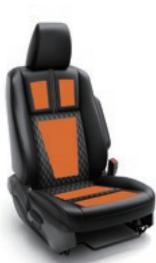
オレンジは、ヒーター加温箇所
