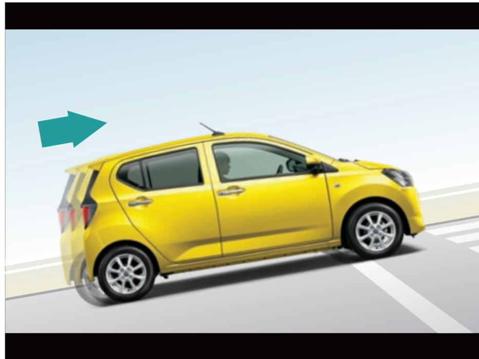
状況に応じてアイドリングストップの作動をコントロールし安心・快適。坂道発進時も安心な機構付です。
