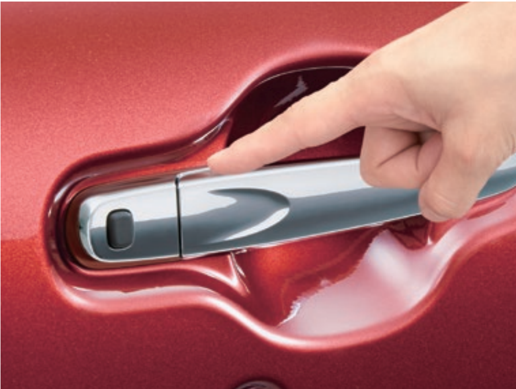
スイッチ操作でドアの施錠・解錠
