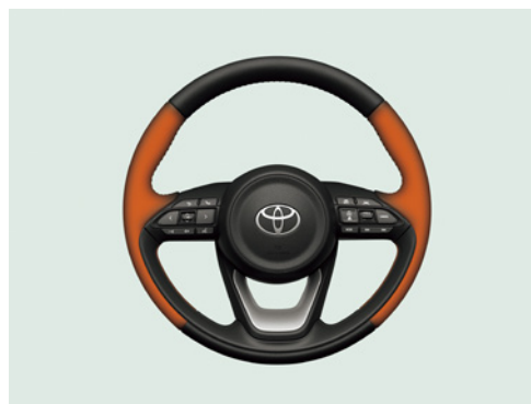
■ヒーター加温箇所
