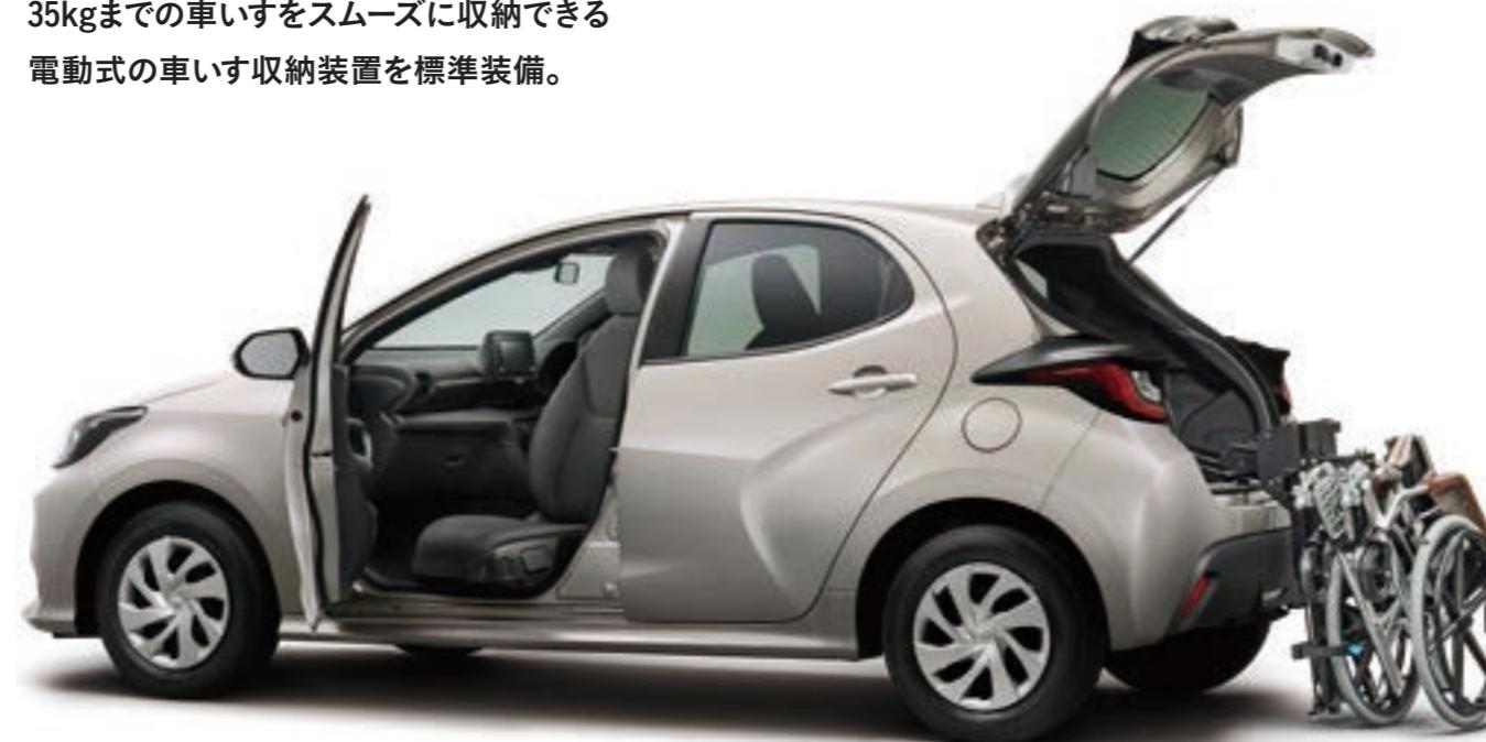
Photo: 1.5X(2WD)車いす収納装置付車“タイプI”。
