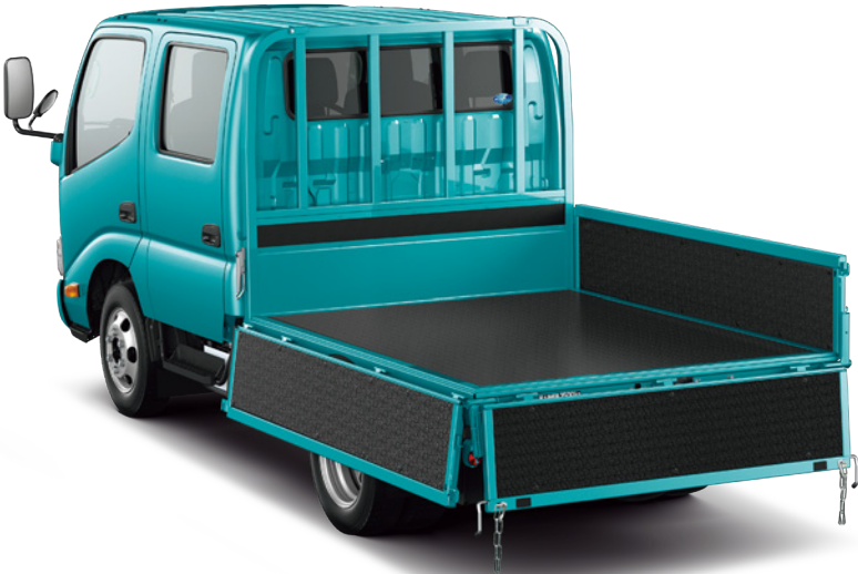
写真はダブルキャブ・2WD・フルジャストロー・ 木製デッキ・1.5トン積・2.8Lディーゼル車。 ボディカラーはターコイズ＜766＞。車型番号 22
