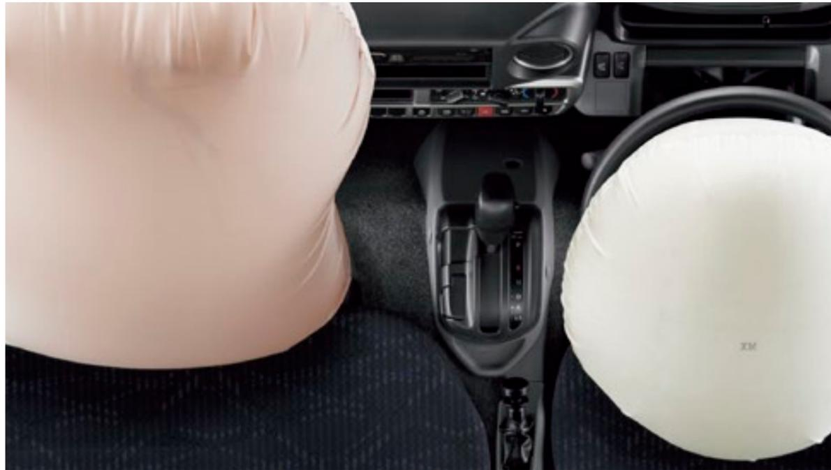
■写真は機能説明のためSRSエアバッグが作動した状態をイメージしたものです。
