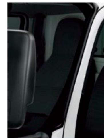
ピラーがあることにより、右目と左目に見えない範囲が生じます。ワイドビューピラーでは左右両視線で見ることにより、従来に比べ死角が少なくなり、運転席からのより確かな視界が確保できます。
