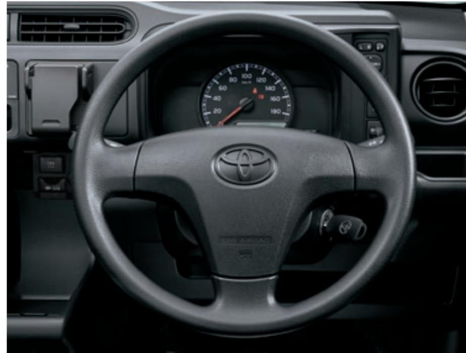
車速感応型電動パワーステアリング
