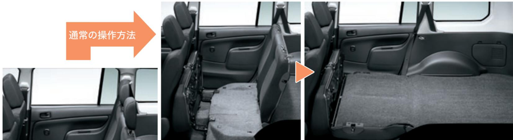
シートベルトを格納し、クッションを引き起こす シートバックを前に倒す ※フロントシートスライド量が制限されます。
