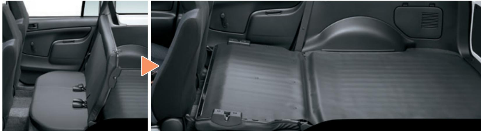
シートベルトを格納し、シートバックを前に倒す
