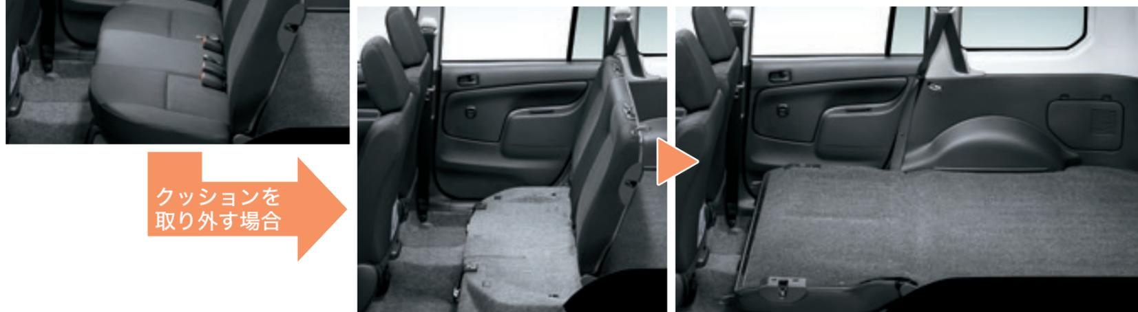
シートベルトを格納後、クッションを取り外す シートバックを前に倒す
