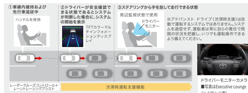
■ドライバーモニターカメラで運転者が周囲の状況を確認し、運転操作できる状態であるかシステムが判断します。システムが運転操作ができない状態と判断した場合は、ブザーとディスプレイ表示で注意喚起を行います\*5。
