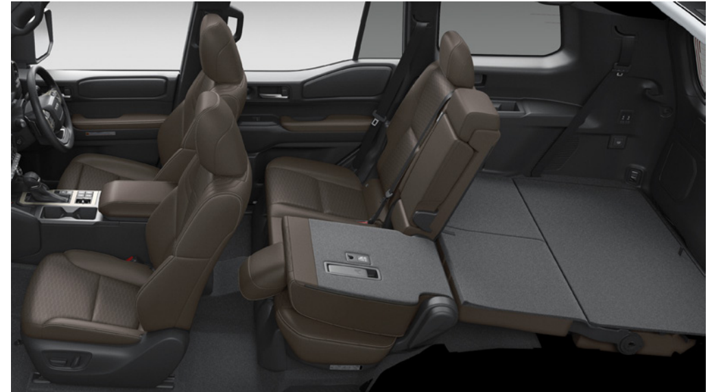
セカンドシート片側前倒し+サードシート両側フロア格納状態
